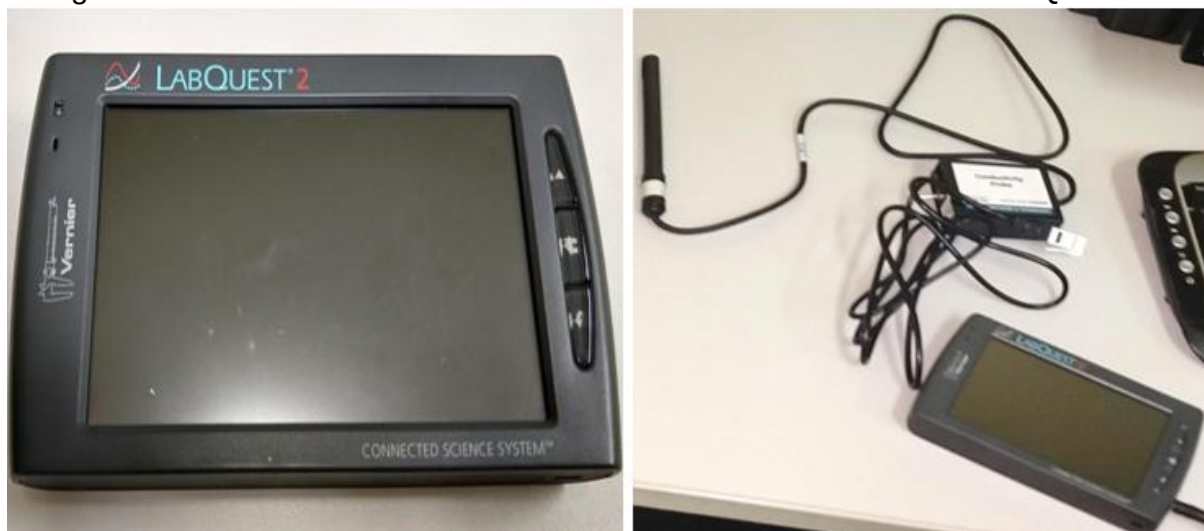
Figura 12: Instrumento e sensor de condutividade elétrica modelo LabQuest® 2.
